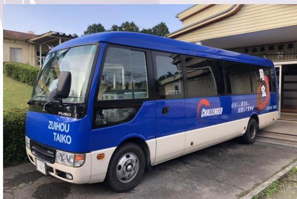
マイクロバス 「幅2m・長さ7.8m・高さ2.7m」
